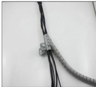
4.包線管通過引線器包住電纜
